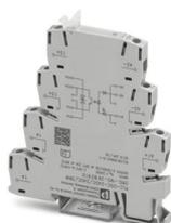
PLC-INTERFACE per applicazioni ferroviarie, composta da morsetto base con connessione a vite e relè a stato solido in miniatura integrato, intervallo: da  $0,7 \times U_N$  a  $1,25 \times U_N$ , intervallo di temperatura:  $-25 \text{ °C}$  bis  $+70 \text{ °C}$ , 1 contatto aperto a riposo, ingresso: 24 V DC, uscita: 3-33 V DC/3 A
