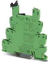
Morsetto base PLC da 6,2 mm, contro correnti e/o tensioni di disturbo sul lato di comando con collegamento a molla, senza equipagg. relè o relè a stato solido, per il montaggio su guida di montaggio, NS 35/7,5, con filtro RCZ integrato, 1 contatto di scambio tens. di ingr.: 230 V DC
