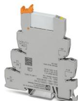
PLC-INTERFACE, composta da morsetto base PLC-BSC.../21 con connessione a vite e relè in miniatura a innesto con contatto universale dorato, per montaggio su guida di supporto NS 35/7,5, 1 contatto di scambio, tensione di ingresso 125 V DC
