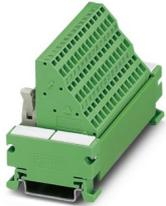
Modulo VARIOFACE con connessione a molla a tre piani e connettore per cavo piatto, per montaggio su NS 35/7.5, n. poli 64
