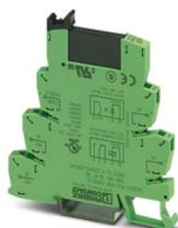
PLC-INTERFACE, composta da morsetto base PLC-BSP.../21 con collegamento a molla e relè a stato solido in miniatura a innesto, per montaggio su guida di montaggio NS 35/7,5, 1 contatto aperto a riposo ingresso: 230 V AC/ 220 V DC, uscita: 24-253 V DC/ 0,75 A
