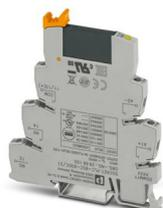
PLC-INTERFACE, composta da morsetto base PLC-BSC.../21 con connessione a vite e relè a stato solido in miniatura a innesto, per montaggio su guida di montaggio NS 35/7,5, 1 contatto aperto a riposo ingresso: 60 V DC, uscita: 24-253 V AC/ 0,75 A
