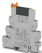
PLC-INTERFACE, composta da morsetto base PLC-BSC.../21 con connessione a vite e relè a stato solido in miniatura a innesto, per montaggio su guida di montaggio NS 35/7,5, 1 contatto aperto a riposo ingresso: 24 V DC, uscita: 24-253 V AC/ 0,75 A
