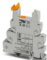
Morsetto base PLC da 14 mm per correnti permanenti elevate con connessione a vite, senza equipagg. relè o relè a stato solido, per il montaggio su guida di montaggio, NS 35/7,5, 1 contatto di scambio tens. di ingr.: 12 V AC/DC
