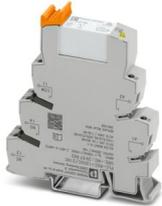
PLC-INTERFACE, composta da morsetto base PLC-BSC.../21 HC con connessione a vite e relè in miniatura a innesto per elevate correnti permanenti, per montaggio su guida di supporto NS 35/7,5, 1 contatto di scambio, tensione di ingresso 120 V AC/110 V DC, corrente limite permanente fino a 10 A
