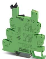
Morsetto base PLC da 6,2 mm con collegamento a molla, senza equipagg. relè o relè a stato solido, per il montaggio su guida di montaggio, NS 35/7,5, 1 contatti di scambio tens. di ingr.: 230 V AC/DC
