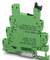
Morsetto base PLC da 6,2 mm per funzioni di input con collegamento a molla, senza equipagg. relè o relè a stato solido, per il montaggio su guida di montaggio NS 35/7,5, con sensore di ripartizione della tensione di alimentazione (BB) 1 contatto aperto a riposo, tens. di ingr. 120 V AC/DC
