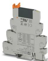
PLC-INTERFACE, composta da morsetto base PLC-BSC.../21 con connessione a vite e relè a stato solido in miniatura a innesto, per montaggio su guida di montaggio NS 35/7,5, 1 contatto aperto a riposo ingresso: 24 V DC, uscita: 3-48 V DC/ 100 mA
