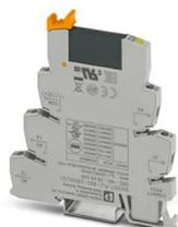
PLC-INTERFACE, composta da morsetto base PLC-BSC.../21 con connessione a vite e relè a stato solido in miniatura a innesto, per montaggio su guida di montaggio NS 35/7,5, 1 contatto aperto a riposo ingresso: 230 V AC/220 V DC, uscita: 3-33 V DC/3 A
