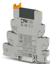
PLC-INTERFACE, composta da morsetto base PLC-BSC.../21 con connessione a vite e relè a stato solido in miniatura a innesto, per montaggio su guida di montaggio NS 35/7,5, 1 contatto aperto a riposo ingresso: 120 V AC/110 V DC, uscita: 3-33 V DC/3 A
