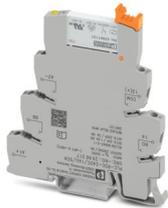
PLC-INTERFACE per funzioni di input, composta da morsetto base PLC-BSC.../SEN con connessione a vite e relè in miniatura a innesto con contatto in oro multistrato, per il montaggio su guida di montaggio NS 35/7,5, 1 contatto aperto a riposo, tens. di ingresso 24 V DC
