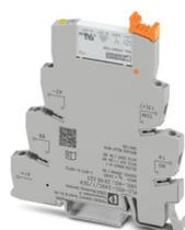
PLC-INTERFACE per funzioni di input, composto da morsetto base PLC-BSC...SEN con connessione a vite e relè in miniatura a innesto con contatto di potenza, per montaggio su guida di montaggio NS 35/7,5, 1 contatto aperto a riposo, tensione di ingresso 24 V DC
