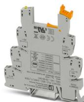
Morsetto base PLC da 6,2 mm per funzioni di input con connessione a vite, senza equipagg. relè o relè a stato solido, per il montaggio su guida di montaggio NS 35/7,5, con sensore di ripartizione della tensione di alimentazione (BB) 1 contatto aperto a riposo, tens. di ingr. 24 V DC
