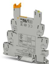
Morsetto base PLC da 6,2 mm per funzioni di output con connessione a vite, senza equipagg. relè o relè a stato solido, per il montaggio su guida di montaggio, NS 35/7,5 con connessione al conduttore di ritorno (BB), 1 contatto aperto a riposo, tens. di ingr. 24 V DC
