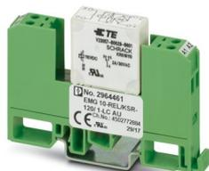
Modulo a relè, con relè saldato, contatto dorato per piccole potenze, 1 contatto in chiusura, tensione d'ingresso 120 V AC/DC
