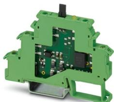
Morsetto a relè a stato solido di ingresso, ingresso: 24 V DC, uscita: 3 - 48 V DC/100 mA, con spina di sezionamento nell'uscita, spessore morsetti 6,2 mm
