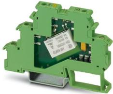
Morsetto a relè per versione sensore, con relè in miniatura saldato, contatto (AgNi+Au): potenze da piccole a medie, 1 contatto in chiusura, tensione d'ingresso 24 V AC/DC, per montaggio su NS 35/7.5, spessore morsetto 6,2 mm
