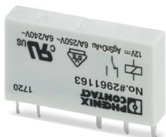
Relè di potenza in miniatura a innesto, con contatto in oro multistrato, 1 contatti di scambio, tensione di ingresso 12 V DC
