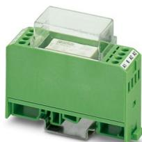
Modulo a relè, con relè in miniatura, con comando a transistor integrato PNP, per basse correnti di comando, contatto (AgNi): potenze da medie a grandi, 1 contatto di scambio, tensione nominale di comando 12 V DC
