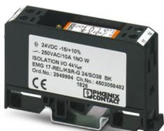
Modulo relè con elevate correnti di spunto, con relè saldato, contatto (AgSnO<sup>2</sup> + W anticipato): potenze da medie a grandi, 1 contatto in chiusura, tensione d'ingresso 24 V DC, corrente d'inserzione max. 80A
