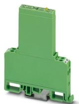
Relè a stato solido di ingresso, con LED e protezione nei circuiti di ingresso e uscita, ingresso: 230 V AC, uscita: 4 - 48 V DC/max. 100 mA
