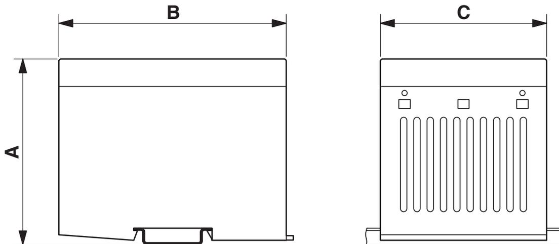
Misura A: 115,5 mm; misura B: 102 mm; misura C: 125 mm
