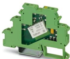
Morsetto a relè, con relè in miniatura saldato, contatto (AgNi+Au): da potenze piccole a medie, 1 contatto in chiusura, tensione d'ingresso 5 V AC/DC, per montaggio su guida DIN, spessore morsetto 6,2 mm
