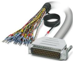
Cavo circolare confezionato schermato; connessione 1: Fili singoli (50-poli) (I conduttori sono siglati e dotati di capocorda. La treccia schermata è prevista su un'estremità separata del cavo.); connessione 2: Connettore maschio D-SUB (1x 50-poli); lunghezza cavo: 1 m
