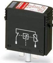
Scaricatore di sovratensioni tipo 2 con varistore di potenza per elemento base VAL-MS, controllato termicamente, segnalazione ottica di guasto. Esecuzione: 580 V AC
