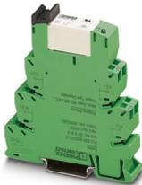
PLC-INTERFACE, composta da morsetto base PLC-BSP.../21-21AU con connessione a molla e relè in miniatura a innesto con contatto universale dorato, per montaggio su guida di supporto NS 35/7,5, 2 contatti di scambio, tensione di ingresso 120 V AC
