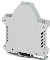
Custodie per guide DIN, Base custodia con piedino di fissaggio in metallo, con contatto FE, di tipo alto, con feritoie di ventilazione, larghezza: 22,6 mm, altezza: 99 mm, profondità: 107,3 mm, colore: grigio chiaro (simili RAL 7035), collegamento trasversale: senza connettore bus, n. poli connettore trasversale: non rilevante
