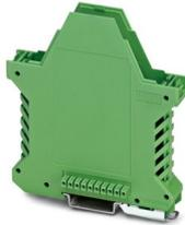
Custodie per guide DIN, Base custodia con piedino di fissaggio in metallo, con contatto FE, di tipo alto, con feritoie di ventilazione, larghezza: 17,6 mm, altezza: 99 mm, profondità: 107,3 mm, collegamento trasversale: connettore bus integrato, n. poli connettore trasversale: 10, Connettore bus: 10 contatti paralleli
