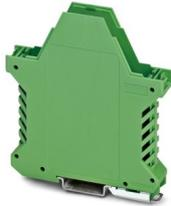
Custodie per guide DIN, Base custodia con piedino di fissaggio in metallo, con contatto FE, di tipo alto, con feritoie di ventilazione, larghezza: 17,6 mm, altezza: 99 mm, profondità: 107,3 mm, colore: verde (simili RAL 6021), collegamento trasversale: senza connettore bus, n. poli connettore trasversale: non rilevante
