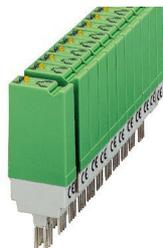
Relè a stato solido di potenza a innesto, con LED e protezione nei circuiti di ingresso e uscita, ingresso: 24 V DC, uscita: 3-30 V DC/max. 5 A, innestabile su morsetti base
