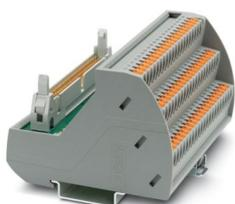
Modulo VARIOFACE con connessione Push-in e connettore maschio per cavo piatto per l'installazione su guide di montaggio NS 35, con connettori maschio e staffe di bloccaggio corte e lunghe per connettori femmina, n. poli: 60, con LED
