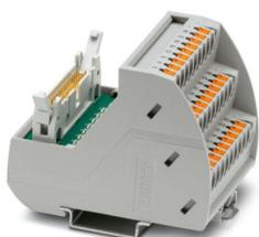
Modulo VARIOFACE con connessione Push-in e connettore maschio per cavo piatto per l'installazione su guide di montaggio NS 35, con connettori maschio e staffe di bloccaggio corte e lunghe per connettori femmina, n. poli: 26, con LED
