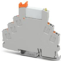
Modulo portarelè montato con connessione push-in, composto da: base relè con espulsore e relè a contatto di potenza. Esecuzione contatti: 1 contatto di scambio. Tensione di ingresso 12 V DC
