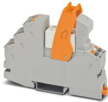
Modulo portarelè montato con connessione push-in, composto da: base relè, relè di contatto multistrato, modulo di segnalazione di stato e di soppressione dei disturbi a innesto e leva di fissaggio. Esecuzione contatti: 1 contatto di scambio. Tensione di ingresso: 24 V AC
