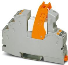
Modulo portarelè montato con connessione push-in, composto da: base relè, relè a contatto di potenza, modulo di segnalazione di stato e di soppressione dei disturbi a innesto e leva di fissaggio. Esecuzione contatti: 2 contatti di scambio. Tensione di ingresso 24 V DC
