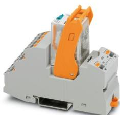
Modulo portarelè montato con connessione push-in, composto da: base relè, relè a contatto di potenza e leva di fissaggio. Esecuzione contatti: 4 contatti di scambio. Tensione di ingresso 24 V DC
