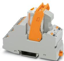
Modulo portarelè montato con connessione push-in, composto da: base relè, relè a contatto di potenza, modulo di segnalazione di stato e di soppressione dei disturbi a innesto e leva di fissaggio. Esecuzione contatti: 4 contatti di scambio. Tensione di ingresso: 230 V AC
