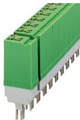
Relè a stato solido di potenza a innesto, con LED e protezione nei circuiti di ingresso e uscita, ingresso: 48-60 V DC, uscita: 15-220 V DC/max. 1 A, innestabile su morsetti base
