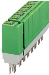
Relè a stato solido di potenza a innesto, con LED e protezione nei circuiti di ingresso e uscita, ingresso: 48-60 V DC, uscita: 24-280 V AC/max. 3 A, innestabile su morsetti base
