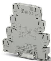
Relè a stato solido di ingresso, frequenza di trasmissione 100 kHz, con LED e protezione nei circuiti di ingresso e uscita, ingresso: 24 V DC, uscita: 4 - 30 V DC/50 mA
