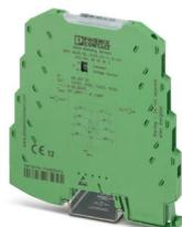
Generatore di tensione costante, tensione di ingresso 9,6-30V DC, tensione di uscita 10V, 7,5V, 5V, 2,5V DC, separazione galvanica, configurabile mediante DIP switch, connessione a vite, configurazione standard
