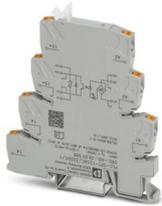
PLC-INTERFACE, relè a stato solido integrato, con connessione Push-in, per il montaggio su guida di supporto NS 35/7,5, ingresso: 120 V AC, uscita: 12-300 V DC/1 A
