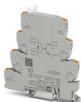
PLC-INTERFACE per applicazioni ferroviarie, composta da morsetto base con connessione Push-in e relè a stato solido in miniatura integrato, intervallo: da  $0,7 \times U_N$  a  $1,25 \times U_N$ , intervallo di temperatura:  $-25\text{ °C}$  bis  $+70\text{ °C}$ , , 1 contatto aperto a riposo, ingresso: 110 V DC, uscita: 3-33 V DC/3 A
