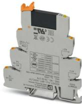
PLC-INTERFACE, composta da morsetto base PLC-BPT.../21 con connessione Push-in e relè a stato solido in miniatura a innesto, per il montaggio su guida di montaggio NS 35/7,5, 1 contatto aperto a riposo ingresso: 60 V DC, uscita: 24-253 V AC/ 0,75 A
