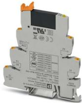
PLC-INTERFACE, composta da morsetto base PLC-BPT .../21 con connessione Push-in e relè a stato solido in miniatura a innesto, per il montaggio su guida di montaggio NS 35/7,5, 1 contatto aperto a riposo, ingresso: 120 V AC/110 V DC, uscita: 3-33 V DC/3 A
