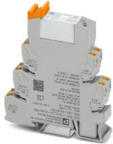
PLC-INTERFACE, per applicazioni ferroviarie composta da morsetto base PLC-BPT.../21 con connessione Push-in e relè in miniatura a innesto con contatto in oro multistrato, intervallo: da  $0,7 \times U_N$  a  $1,25 \times U_N$ , classe di temperatura TX: da  $-40 \text{ °C}$  a  $+70 \text{ °C}$ , 2 contatti di scambio, tens. di ingresso 110 V DC
